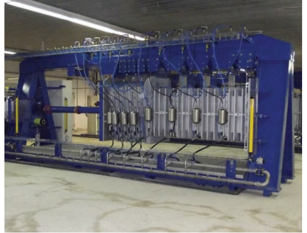
ترتيب الأحواض وأعمدة السند (الركبة) لكالات متعددة لإنتاج الخزانات والأعطية
