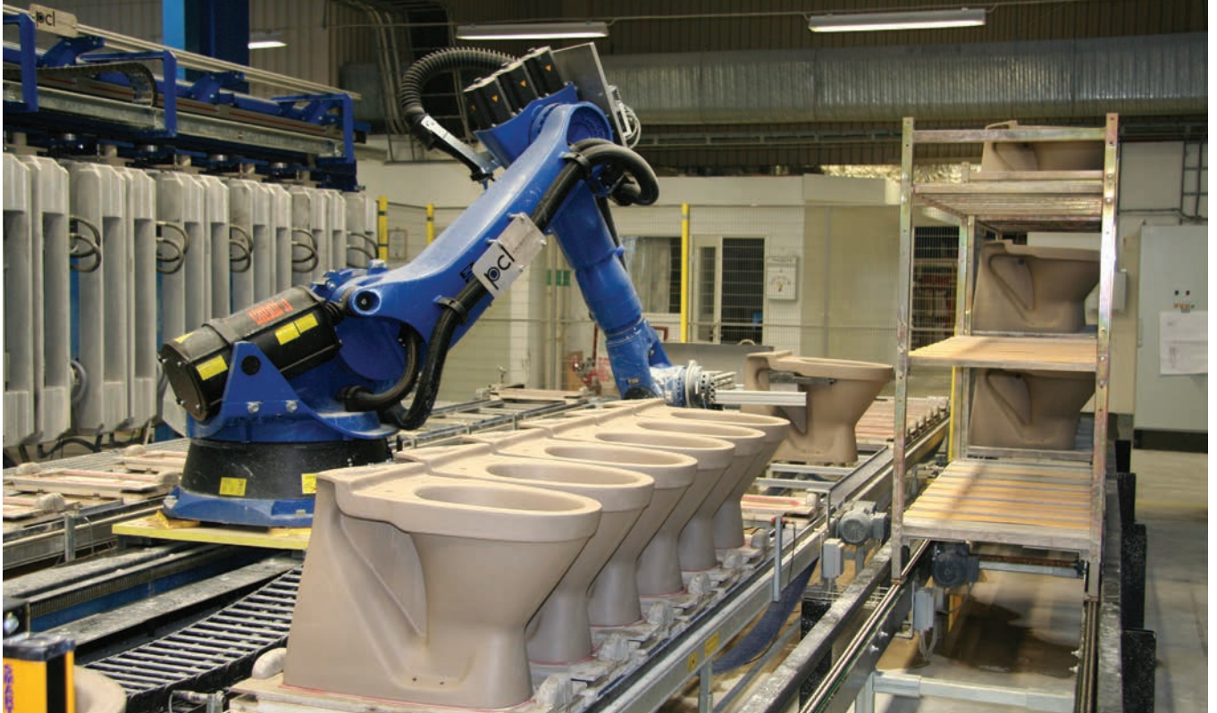
السبك الآلي الكامل للمراحيض المكونة من خمسة أجزاء
